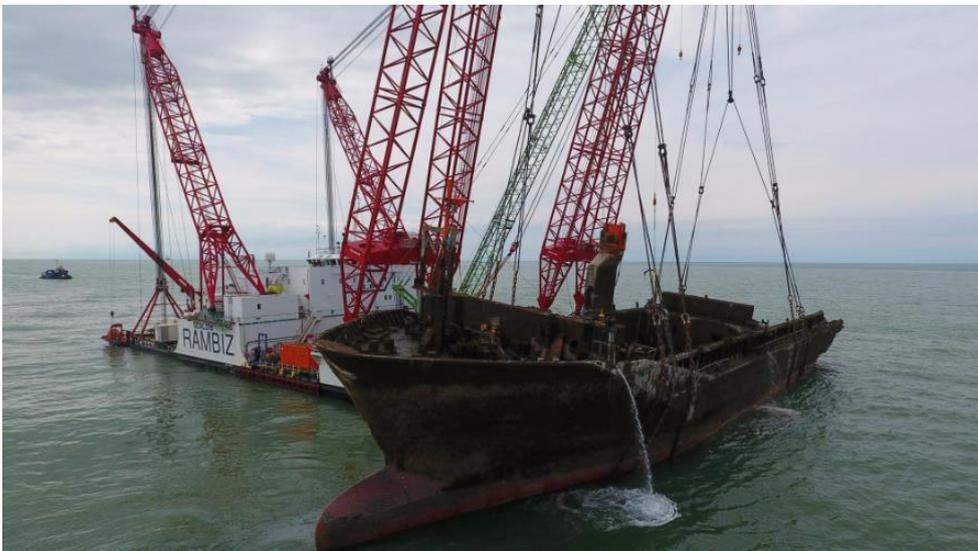
货船残骸的打捞工作花费了很长时间。通过使用浮式起重器回收了第一部分。
