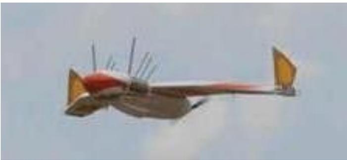
4月3号--美国海军正在研发外形如鸭子的无人机-Flimmer（飞行游泳者缩写），既可以在空中飞行也可以在水中航行。通过在水面以上飞行，该无人机可以更快地到达作业区域。
