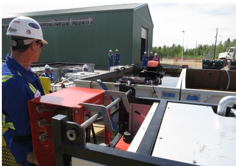
图 19 在艾伯塔盖恩福德进行的收油机测试。
