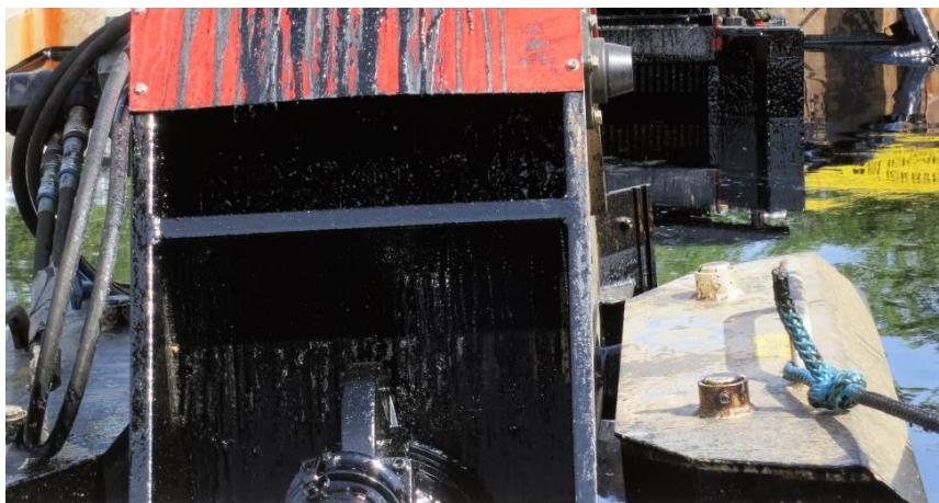
图 18. 在风化 Dilbit 回收试验中使用的 LAMOR 收油机。
