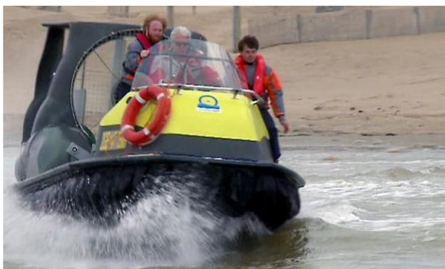
MACP（多功能气垫式操作平台）设计理念源于制造尺寸符合起落架的柴油驱动小型气垫船的需求，这样可以进行简易运输。柴油驱动气垫船规格符合欧盟作业船法律和专业操守。
