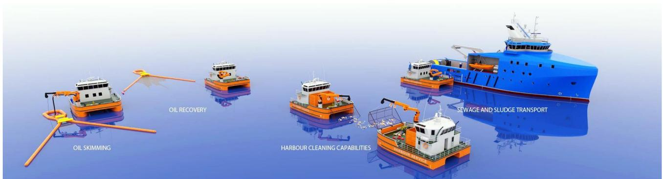
新一代港口服务作业船舶将用于港口安全快速回收溢油，运输污水和清理垃圾。该船配备额外两个机舱和发动机系统。船上安装可供 2 人生活区和食堂。甲板设计为可存储尺寸为 3×20 英尺集装箱。
