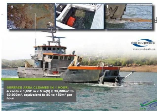
由于近几年国际环境保护问题引起人们的高度重视，FORMOSA PETROCHEMICAL CORPORATION (FPCC) 2014 年订购了一款新型用于海岸线一带的溢油回收船，Eco 设备有限公司（中国台湾代理商）赢得了这次造成合同。由 ECOCEANE（法国）研发生产，估计该船将于 2015 年初完成。Spillglop250 型号（SG250）是一艘总造价为 6,000,000 美元的铝制溢油回收船舶。船舶总长度为 25 米。除了具有每小时可以回收 150 米溢油能力外，SG250 可以作为一艘真正的施工船，同时还可以进行产生较高收益的作业活动。这艘船将成为中国台湾第一艘特制的铝制溢油回收船，同样也是亚洲第一艘最先进的溢油回收船。FPCC 公司研制的新型回收船将帮助解决中国台湾发生的溢油污染事故以及该公司计划使用该船帮助该地区其他国家应对海洋污染问题。
