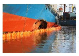
图片: 导致MV Siderfly 号在德国基尔运河下沉两个缺口的其中一个。图片是由CCME提供
