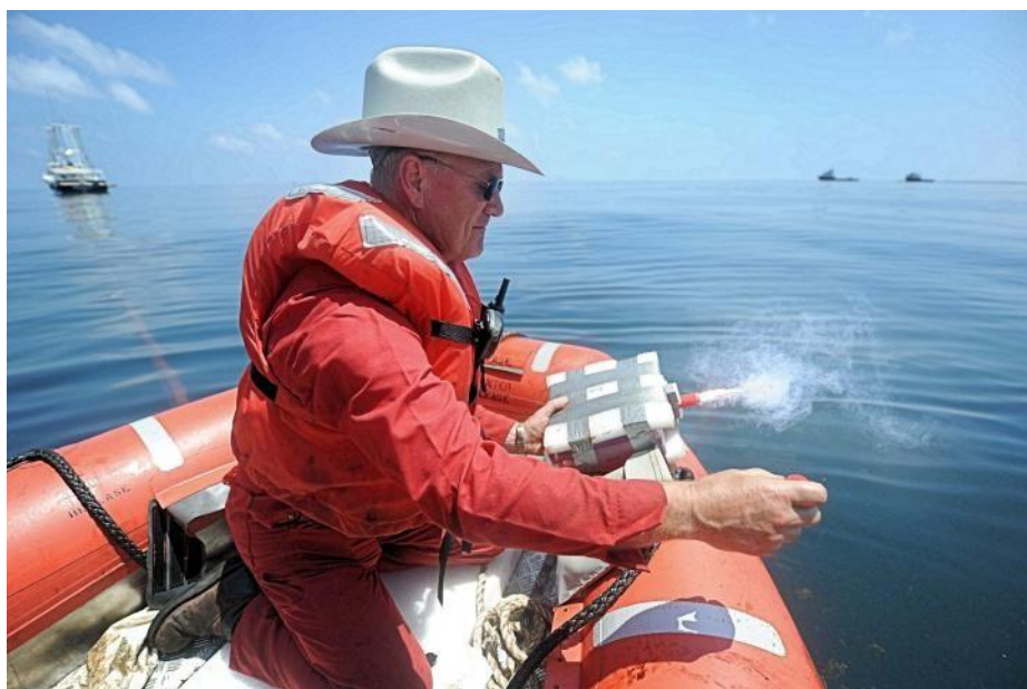
图22 操作人员在深海地平线溢油事故中点燃了一个点火设备。该设备是由一个装有胶凝柴油瓶子和海上遇难信号弹组成。海上遇难信号弹融化了作为底漆和燃烧引发剂的柴油。
