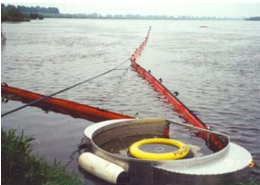
名为 Capt Blombergs 水力环形收油设备现在用于专用于河流溢油应急设备
