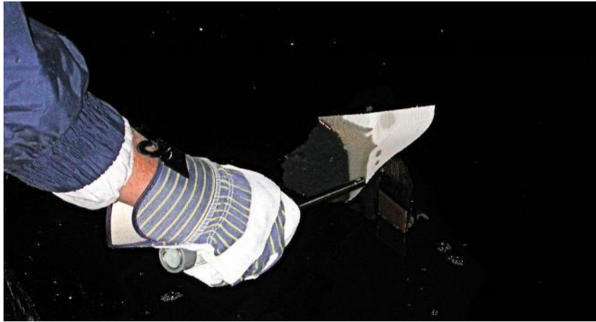
图18 点燃重型石油的方法。通过加入少量如柴油（大约20毫升）等助燃燃料以及加入如纸板或一次性毛巾作为助燃物质棉芯使点燃重型原油的过程更为简易。
