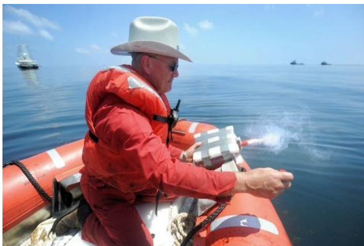
图片 7—在墨西哥湾深海地平线溢油事故中经常使用自制点火器已被点燃并准备放入飘在海上的溢油上。（图片由 Elastec/American Marine Inc. 提供）
