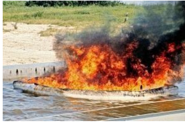
图 5 在美国海岸警卫队对耐火围油栏进行的测试中使用美国材料协会协议的移动设备。使用与图 4 相似的方法对该实验中产生的烟雾进行测量。
